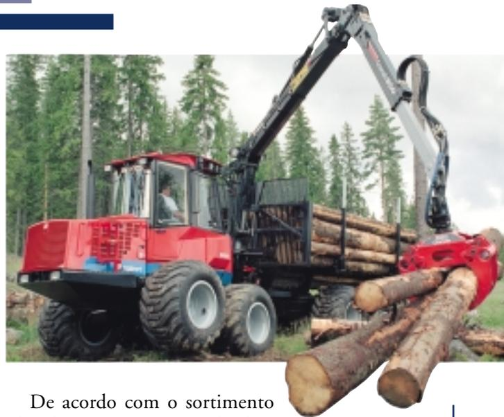
De acordo com o sortimento adotado, as toras são marcadas durante o processo de colheita, através de um dispositivo incorporado ao cabeçote do *harvester*.
