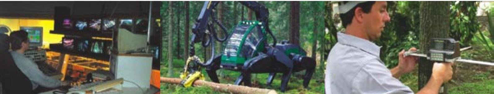
O *hardware* existente na cabine do *forwarder* informa o peso da carga de cada grua, bem como o peso total e o volume da carga do *forwarder*. Um relatório pode ser transferido para um PC ou impresso no interior da própria cabine. As medições também podem ser transferidas via telefone celular e as especificações das toras podem ser remotamente transferidas para o computador de bordo do *forwarder*.
